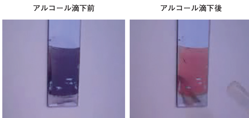
図7 アルコール滴下前後での金ナノ粒子分散酸化チタンインバースオパールの色の変化
